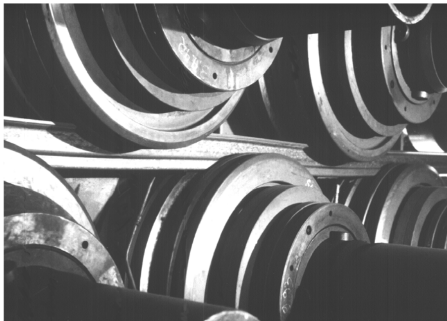
Abb. 7.9: Richtrollen und Richtgut in einer Rollenrichtmaschine
